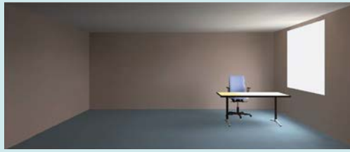
Abb. 75: Verbesserte Verteilung des Tageslichtquotienten auf Höhe der Nutzenebene
