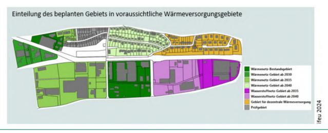
Abbildung 27: Exemplarische Darstellung für die Einteilung des beplanten Gebiets in voraussichtliche Wärmeversorgungsgebiete in den Stützjahren. Quelle: Darstellung ifeu
